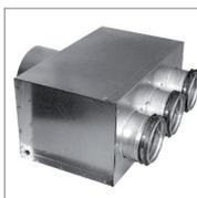
Plenum in lamiera di acciaio zincato per mandata e ripresa dell'aria per installazione a controsoffitto. Configurazione in line. Progettati per montaggio di bocchette circolari. Attacchi con guarnizioni.
