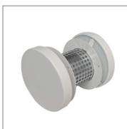
Griglia di transito circolare afonica con canotto telescopico per spessori da 90 a 170 mm. Deflettori in acciaio zincato verniciati a polveri RAL 9010 bianco gloss 30. Passante preforato in acciaio inox. Isolamento interno in lana minerale.
