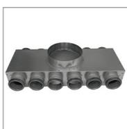
Plenum di distribuzione in lamiera di acciaio zincata per mandata e ripresa dell'aria. 10 attacchi Ø 63 mm con guarnizione. Installazione a parete/pavimento/soffitto.
