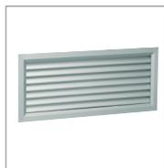
Griglia di ripresa con alette inclinate fisse, passo 25 mm, esecuzione in alluminio estruso anodizzato naturale, fissaggio a clips
