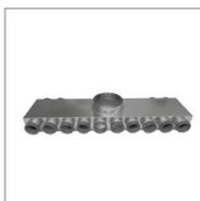
Plenum di distribuzione in lamiera di acciaio zincata per mandata e ripresa dell'aria. 14 attacchi Ø 63 mm con guarnizione. Installazione a parete/pavimento/soffitto.
