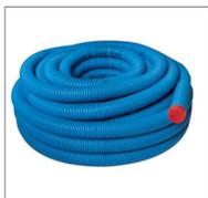
Canale corrugato semiflessibile liscio internamente in PEAD (polietilene ad alta densità) a doppia parete. Trattamento antiestinguente esterno, antistatico interno. Utilizzabile per sistema di distribuzione a pavimento (calpestabile).
