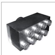
Plenum di distribuzione in lamiera di acciaio zincata per mandata e ripresa dell'aria. 6 o 8 attacchi Ø 63 mm con guarnizione. Installazione in controsoffitto.
