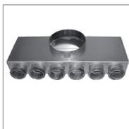
Plenum di distribuzione in lamiera di acciaio zincata per mandata e ripresa dell'aria. 6 o 8 attacchi Ø 63 mm con guarnizione. Installazione a parete/pavimento/soffitto.
