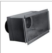
Plenum in lamiera di acciaio zincato per mandata e ripresa dell'aria per installazioni a controsoffitto. Configurazione in line. Progettato per montaggio di griglie 300x100 mm, 3 attacchi Ø 63 mm e 200x100 mm, 2 attacchi Ø 63 mm. Cornice telescopica in dotazione per facilitare l'installazione. Attacchi con guarnizioni.
