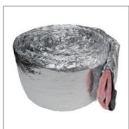
Guaina flessibile isolante per tubazioni rigide. Condotto interno in alluminio, rivestimento in lana di roccia, camicia esterna in pellicola PVC riflettente.
