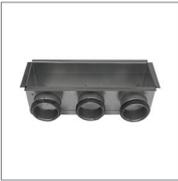
Plenum in lamiera di acciaio zincato per mandata e ripresa dell'aria per installazioni a parete, può essere utilizzato anche per installazioni a soffitto. Progettato per montaggio di griglie 300x100mm o 200x100mm. 2 attacchi Ø 63 mm. Cornice telescopica in dotazione per facilitare l'installazione. 3 attacchi Ø 63 mm. Cornice telescopica in dotazione per facilitare l'installazione.
